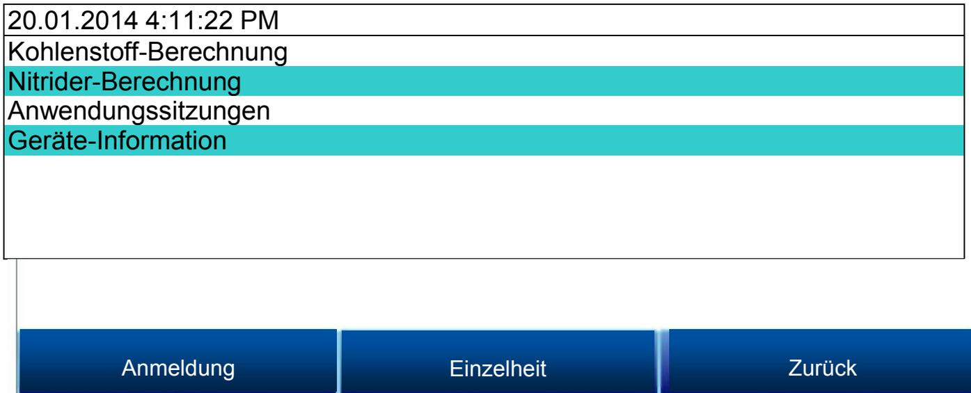
Auf die Punkte Kohlenstoff-Berechnung, Nitrid-Berechnung, Anwendungssitzungen und Geräte-Informationen kann jeder Benutzer zugreifen. Zusätzliche Menüpunkte stehen nach Anmeldung eines berechtigten Benutzers über ein entsprechendes Passwort zur Verfügung. Die Eingabe des Aufsichts-Passworts (Standardeinstellung = 1) ermöglicht dem Benutzer auch einen Zugriff auf den Kontrollbildschirm der Pumpe.
