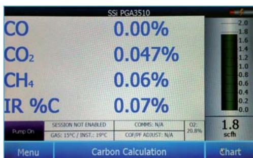
Die Messergebnisse können in Graphen umgesetzt werden, die Fehler im Ofen oder bei der Schutzgaskatalyse durch Abweichungen in der Atmosphären-Zusammensetzung sichtbar machen.
